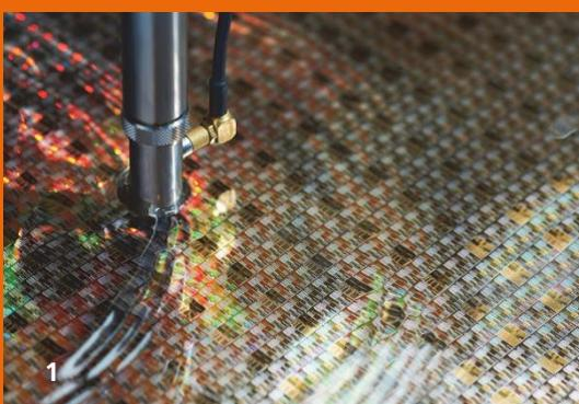
1 Prüfkopf scannt einen Wafer.
