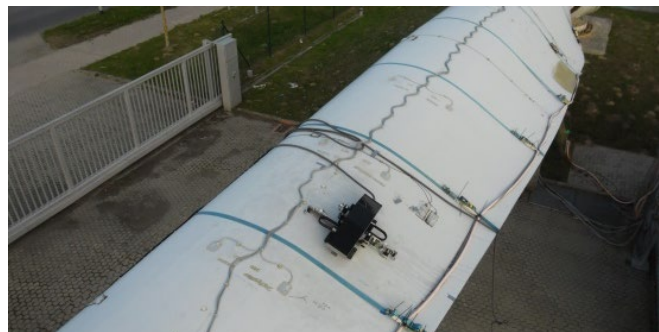
Ultraschall-Scanwagen während eines Diagnosescans auf einem Rotorblatt für Windenergieanlagen (WEA).
