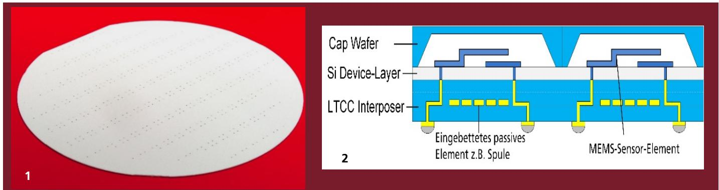
1 Polierter LTCC-Wafer mit Gold-Vias für das anodische Bonden mit Silizium-MEMS-Wafer.
