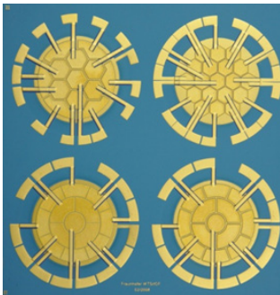
PZT-Dickschichtaktoren auf LTCC zur Fertigung adaptiver Spiegel (Fraunhofer IKTS, Fraunhofer IOF).
