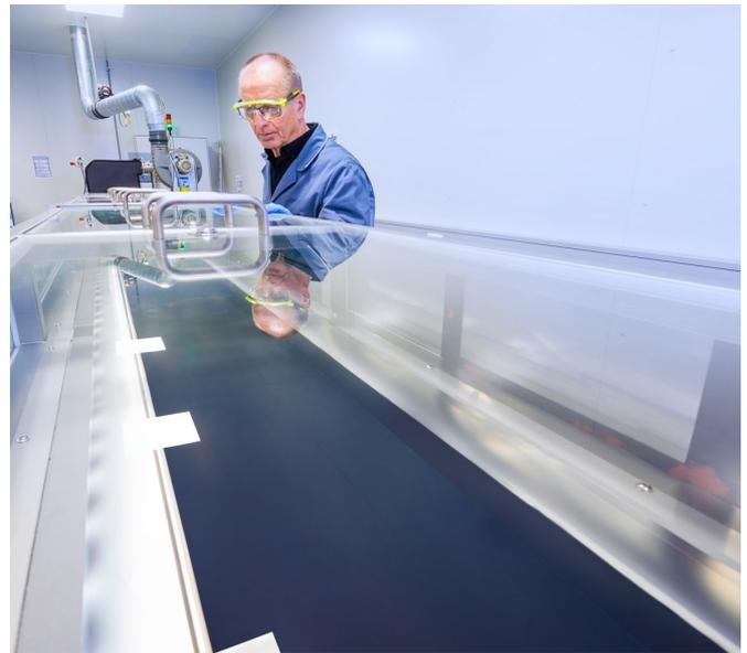
Herstellung von Elektroden für Li-Ionen-Batterien.
