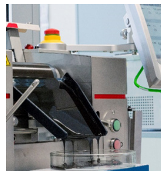
Homogenisierung der Paste auf einem Walzenstuhl.
