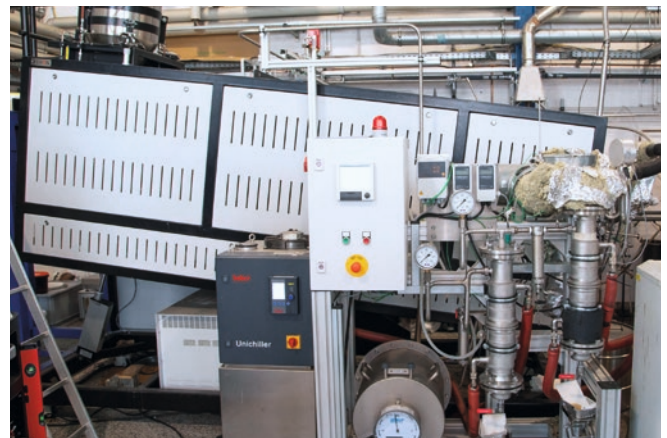
Bild 1: Pyrolyse-Drehrohrofen im Technikumsmaßstab mit eigens konzipierter und gebauter Kondensationsanlage im Vordergrund.
