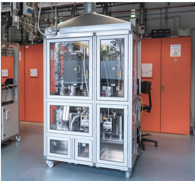
Bild 1: Reaktorteststand zur Durchführung der Degradationsuntersuchungen.
