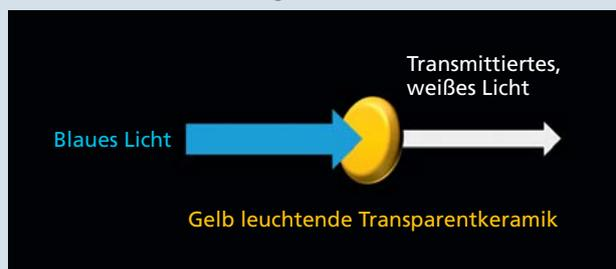
In Transmissionsanordnung durchläuft der Lichtstrahl nur einmal das keramische Material während in Reflexionsanordnung
