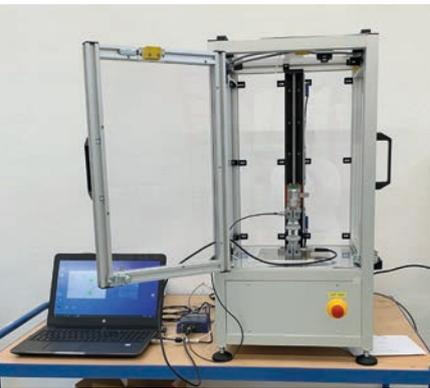
Vertikalachsenmesssystem zur Charakterisierung von Suspensionen mit Ultraschall.
