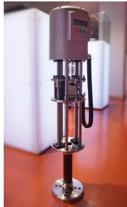
Gesamtansicht der Prüfmaschine für Belastungen in CT-Anlagen.
