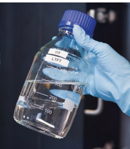
FT-Rohprodukt mit sichtbarer wässriger und öligere Phase.
