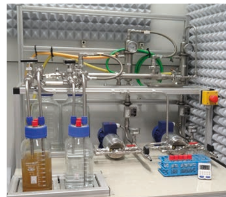
Technikumsanlage mit Membrankontaktor zum Nährstoffrecycling.
