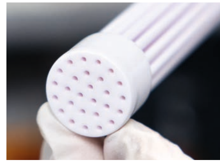
Keramische Kapillarmembranen mit hydrophober Beschichtung.
