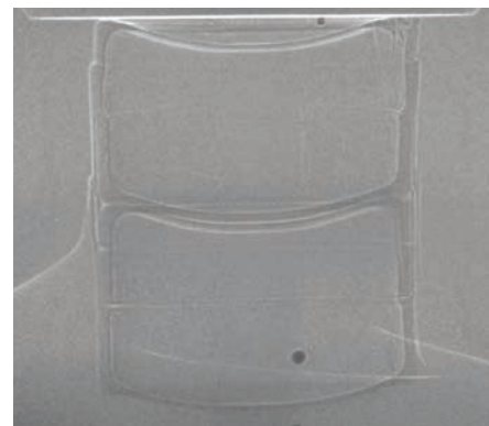
Set von zwei gestapelten Frusteln, die während des vertikalen In-situ-Druckversuchs aufgenommen wurden.
