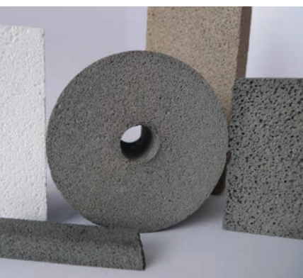
Direktgeschäumte keramische Bauteile aus verschiedenen Materialien mit unterschiedlicher Porosität.
