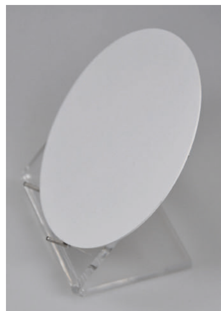
Scheibenförmiger Festkörperelektrolyt aus Natrium-Beta-Aluminat.
