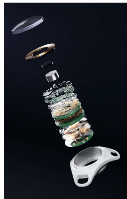
Spinell-Gehäuse mit Grundplatte (Quelle: Wilddesign GmbH).
