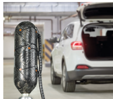
Dauerhafte Überwachung von Drucktanks mit geführten Wellen.
