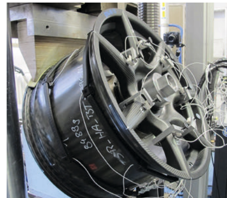
Prüfung einer CfK-Felge mit Schallemission.
