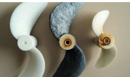
Propeller mit (mitte) und ohne Beschichtung (rechts) nach Tribotests im Labor.
