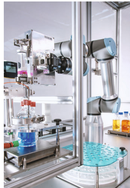
Automatisierter, robotergestützter Abbau und Analytik von Wasserschadstoffen.
