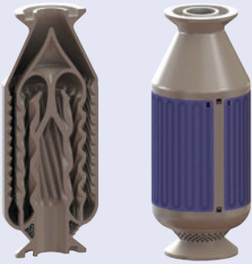
CAD-Rendering des Reaktors: Schnitt durch Substrat (links); Gesamtstruktur inklusive Heizerstruktur (rechts).
