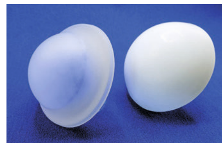
Komplexe gekrümmte MgAl_2O_4 -Keramik mit unterschiedlichen Wandstärken (links) und Al_2O_3 -Keramik (rechts).
