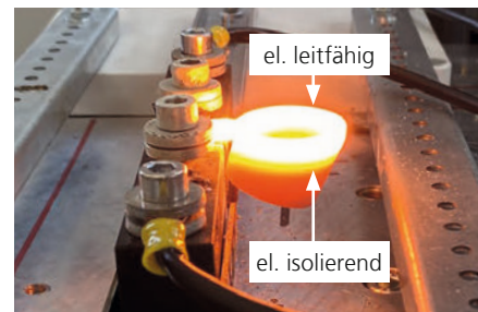
Mit CerAM FFF gedruckter keramischer Heizer im Betrieb (Partner: PolyMerge GmbH, 3D Ceram Sinto Tiwari).
