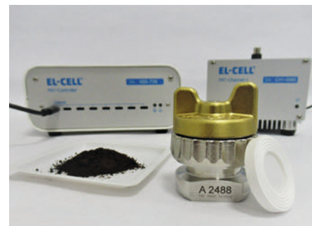
Messzelle mit Natrium-Beta-Aluminat und Übergangsmetalloxid-Aktivmaterial (Quelle: EL-CELL).
