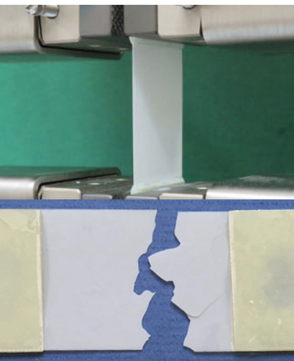
Bestimmung der Festigkeit von 90 µm dickem 3YSZ-Substrat im Zugversuch.
