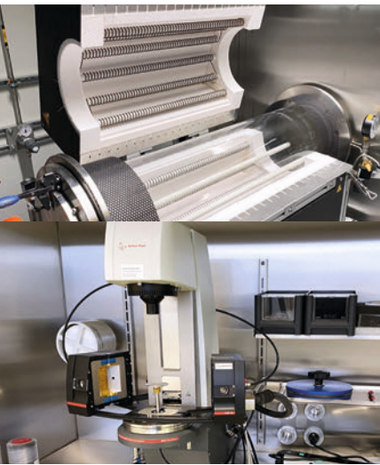
Messung von feuchte- und luftempfindlichen Proben. Oben: Ofen integriert an Ar-Glovebox, unten: Rheometer integriert in Ar-Glovebox.
