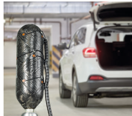
Dauerhafte Überwachung von Drucktanks mit geführten Wellen.
