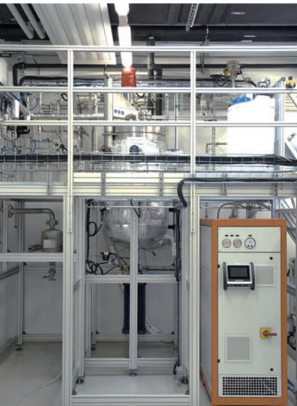
Pilotanlage zur Lithium-Rückgewinnung unter Anwendung des COOL-Verfahrens.
