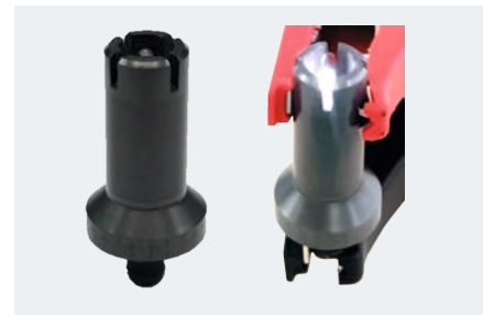
Mit CerAM MMJ gedruckter keramischer Zünder: co-gesintert (links); im Betrieb (rechts).
