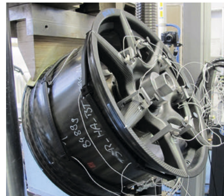
Prüfung einer CfK-Felge mit Schallemission.
