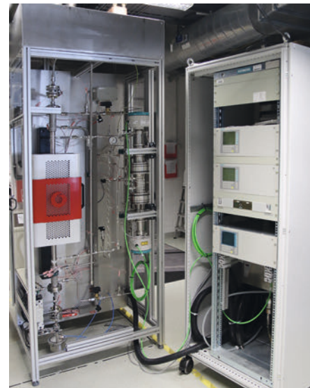
Direktreduktionsanlage im Labormaßstab.
