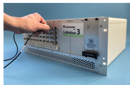
Akustisches Messsystem mit 32 Kanälen.
