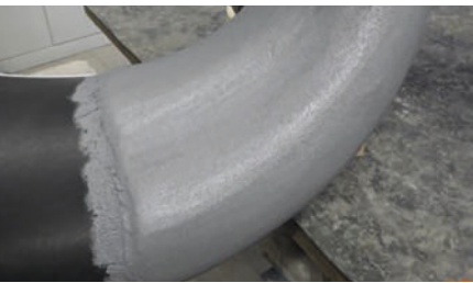
Pilotpropeller während des Beschichtungsprozesses (Quelle: SiCcast GmbH).
