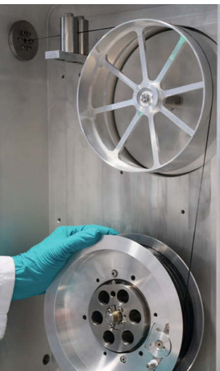
Wickelwerk mit beschichtetem, aufgewickeltem Faser-Roving.
