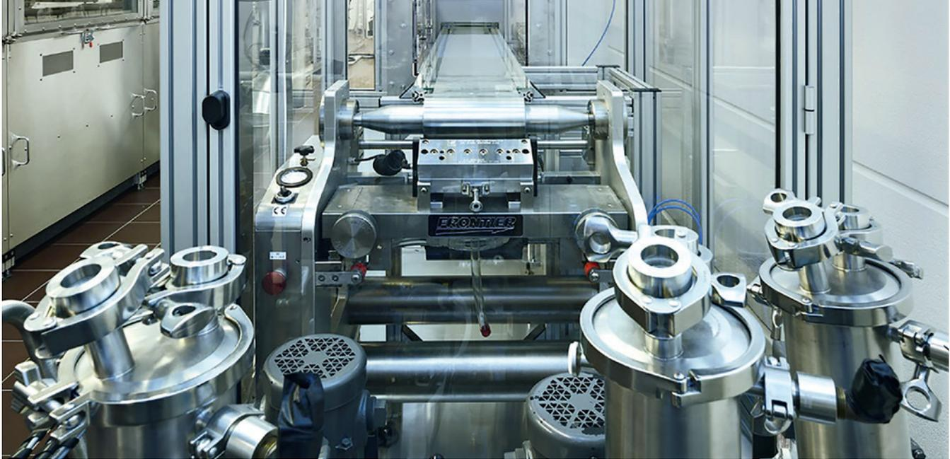
Technologieentwicklung für Mehrfachbeschichtung mittels Triple-Slot-Die-Coating.
