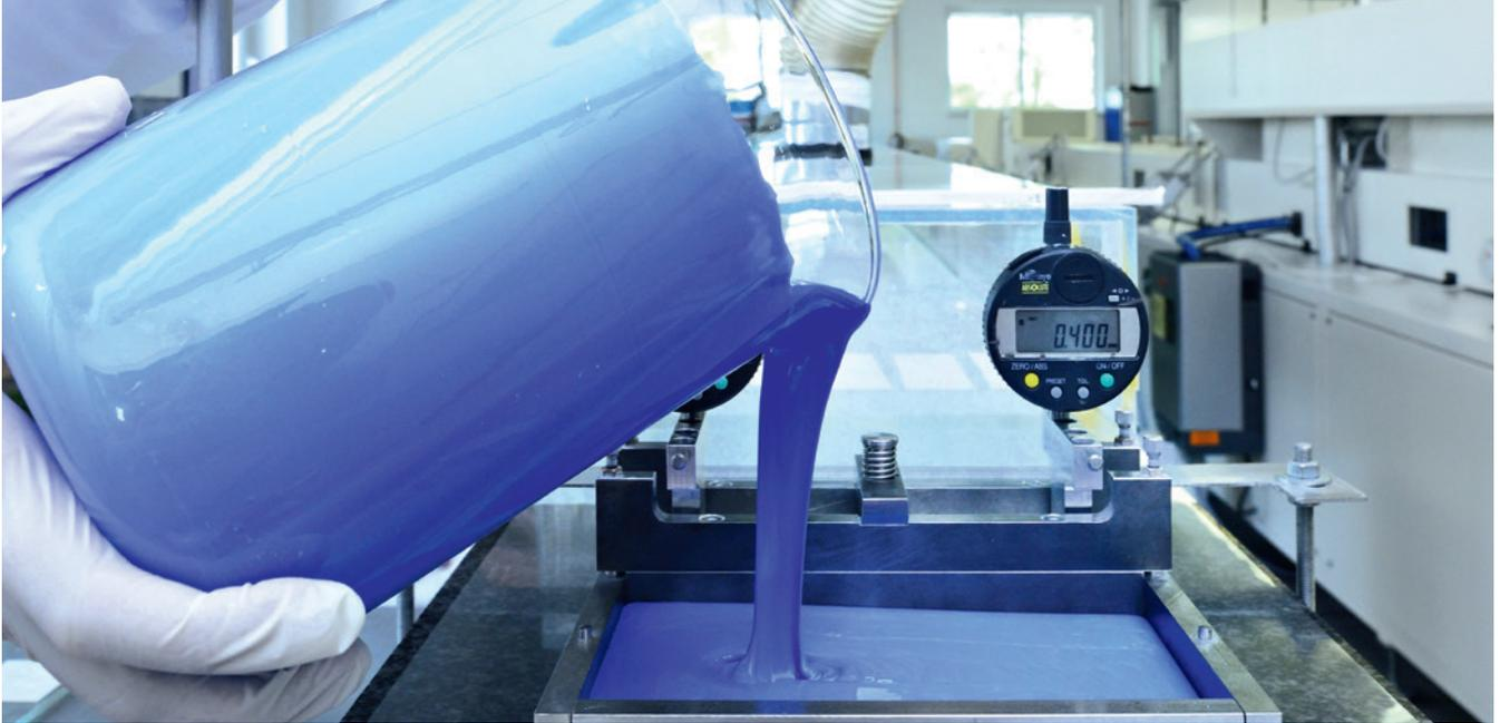
Dosierung des Schlickers in den Gießkasten.
