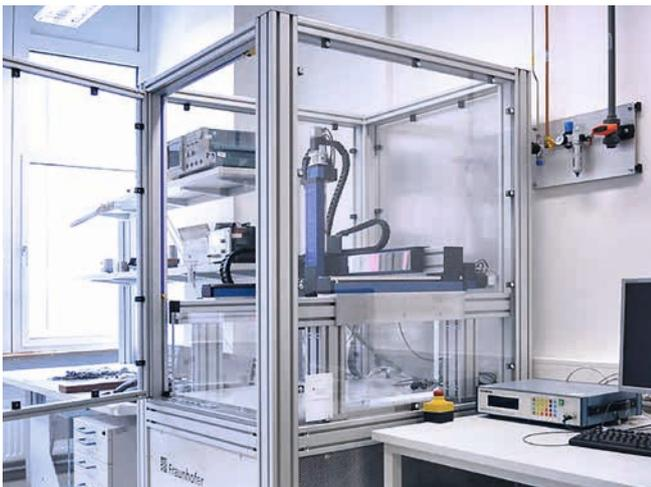
*Laborsystem des Ultraschall-Scanners VARIUS zur Detektion von Hohlräumen und Rissen in Schweiß- oder Klebverbindungen und weiteren Fehlern in Verbundwerkstoffen.*
