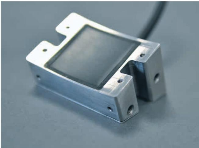
*Mechanisch fokussierender Phased-Array-Prüfkopf.*
