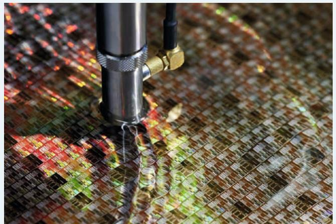
Ultraschall-Prüfkopf scannt einen Wafer.
