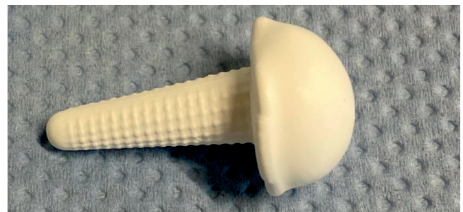
Gegossenes patientenspezifisches Fingergelenksimplantat aus ATZ.
