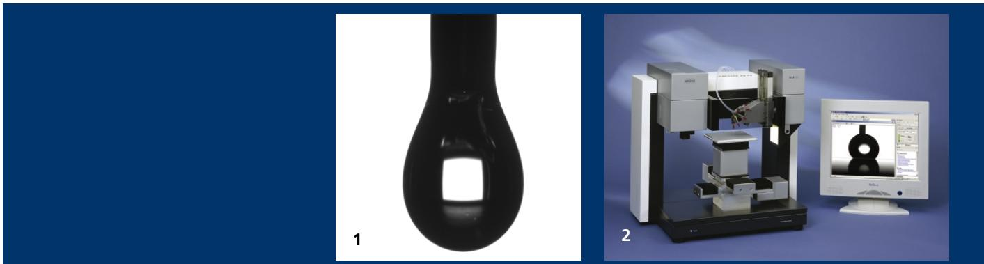
1 Methode des hängenden Tropfens zur Messung der Oberflächenspannung.
