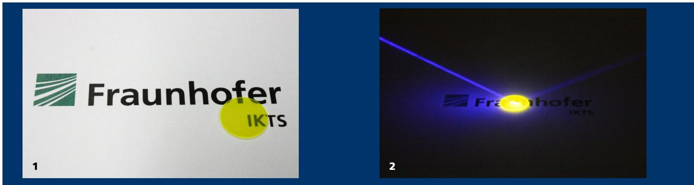
1 Transparente, polykristalline YAG:Ce-Keramik hergestellt aus Leuchtstoffpulver.
