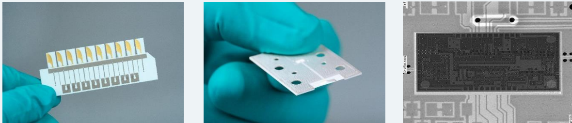
Abbildung 1: Freitragende LTCC-Antennenstruktur mit 10 parallelen Vivaldi-Antennen in einem gestuften Substrat (links), Breitbandige 140 GHz Vivaldi-Antenne mit 50 µm dünner LTCC-Membran für Antennenflügel (Mitte), Röntgenaufnahme eines LTCC-Gehäuses mit integriertem 140 GHz-Chip (MMIC) und Patch-Antenne (rechts).
